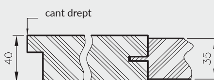
Secțiunea orizontală a foii de ușă Scala, Trevi, Berge
